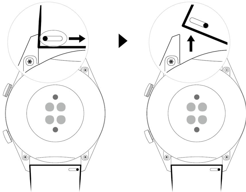
Чтобы снять металлический браслет, выполните действия, показанные на рисунке ниже.
