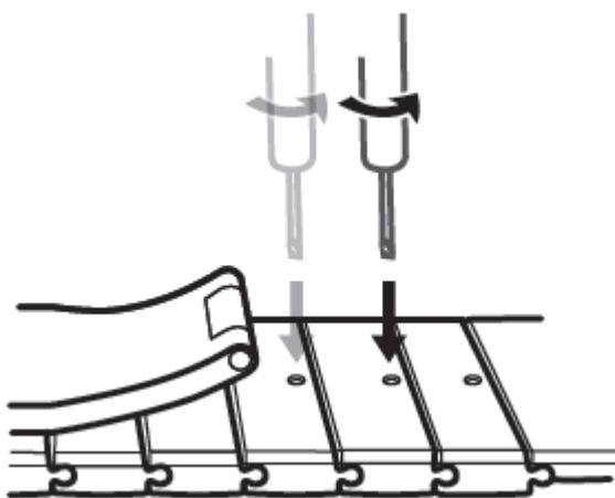
2. Снимите равное количество звеньев с каждой стороны, чтобы сохранить центральное положение корпуса часов.
